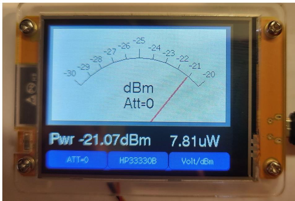
Ce wattmètre numérique utilise une sonde détectrice à diode de chez Hewlett Packard type HP33330B. Cette sonde possède une sortie de tension négative.
